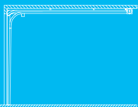
Prowadzenie typu LHR Niskie – ze sprężyną z tyłu
